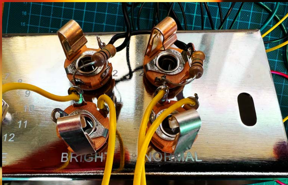
Genom att först placera ingångjacken i hålen från utsidan, blev det mycket lättare att komma åt att löda.
